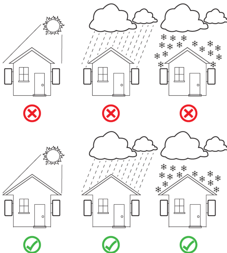
Рисунок 4.1. Рекомендации по выбору места для установки инвертора.
