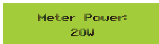
Рисунок 7.36. Включённая функция нулевого экспорта через счётчик энергии.
