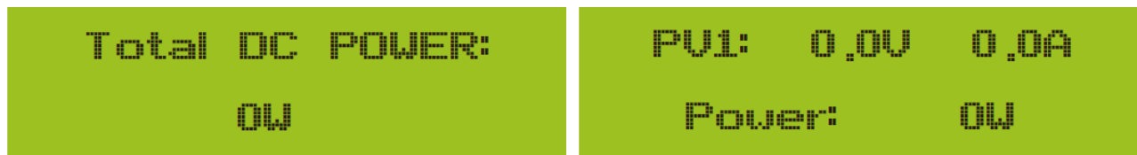
Рисунок 8.3. Информация о напряжении и токе на входе фотоэлектрических модулей.
